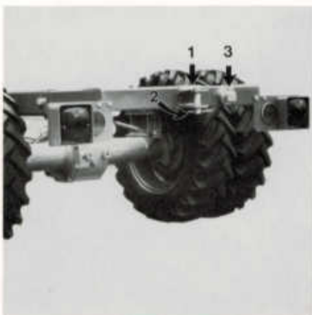
Fig. 12: Prise de courant sur la traverse arrière du châssis 1 Accouplement pour remorque 2 Goupille à ressort 3 Prise de courant
