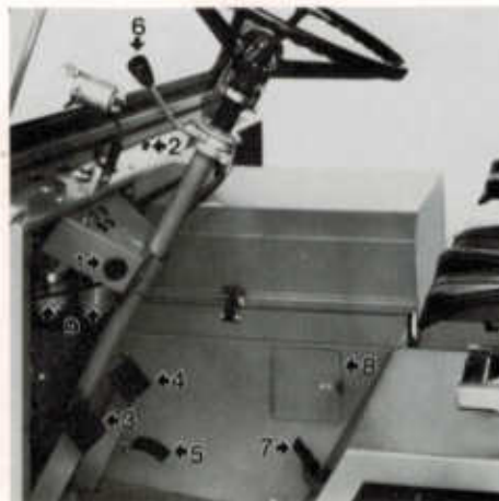
Fig. 6: Emplacement du conducteur 1 Commutateur de la lampe d'avertissement 2 Tirette pour mélange riche (départ à froid) 3 Pédale d'embrayage 4 Pédale du frein 5 Pédale de l'accélérateur 6 Manette de carburation 7 Pédale de verouillage du différentiel arrière 8 Lucarne d'accès au moteur 9 Réservoirs de fluide de frein
