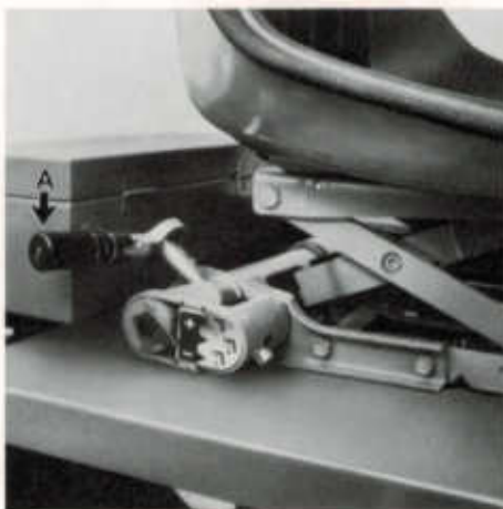
Abb. 12: Rahmenteil hinten 1 Anhänger-Kupplung 2 Feder-Vorstecker 3 Steckdose
