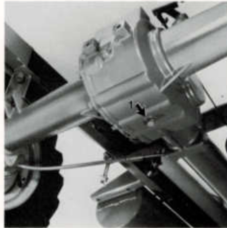
Fig. 22: Mécanisme différentiel arrière 1 Vis de vidange d'huile
